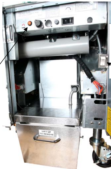
Kuva 4: koottu sulaminen Yksikkö näkyy paikallaan.
