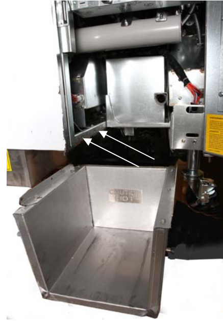
Kuva 1: Sijoita sulaminen yksikkö kaappiin ja kiinnitä edellyttäen ruuveilla kaapin sisätilat.
